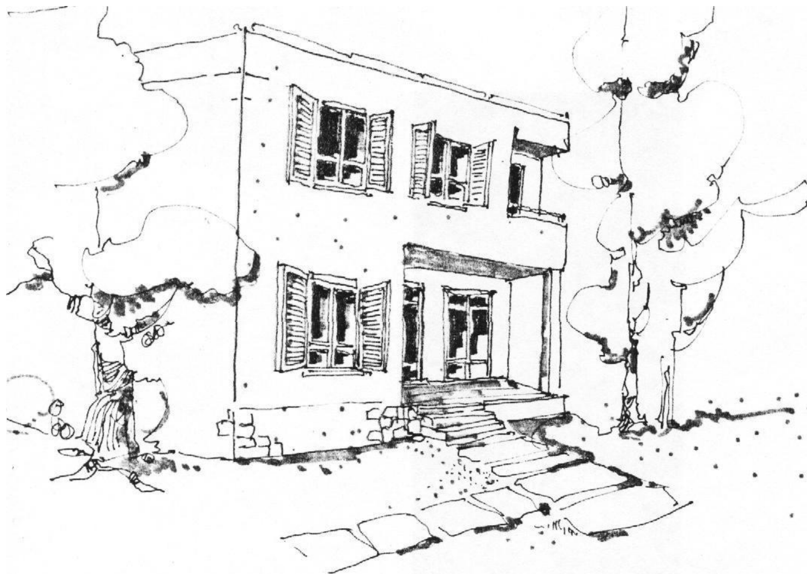
نصب دریچه چوبی یا شبکه متحرک عایق در پشت پنجره‌ها از نفوذ مستقیم تابش حرارت زای خورشید به فضاهای داخلی جلوگیری می‌کند (طرح از محمد خسروشاهی).
